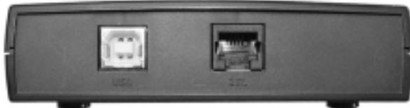
USB-Anschluss für den Prestige 630C(-I) an Computer und ADSL-Anschluss.
